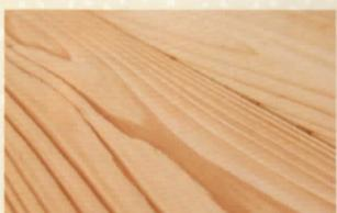
「うづくり(浮造り)」とは、美しい木目を引き立てるために、床材表面の木目の固い部分だけを浮き彫り状に残す仕上げ方法で木目に沿った凹凸を再現し、天然木ならではの美しさをより際立たせると共に、凹凸による肌で触れた時の心地よさを感じることができ、健康的で自然感、素材感を演出します。
